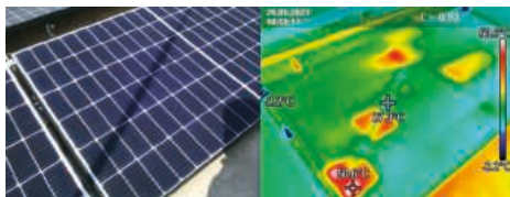
Abb. 2 Verschattung und Hotspots durch Blitzfangstange 2
