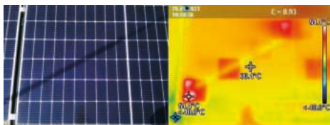
Abb. 1 Verschattung und Hotspots durch Blitzfangstange 1
